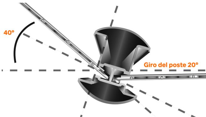
**A** Para cambios de dirección es necesario colocar un poste esquinero y hacer un cambio de dirección a 90°. Sin embargo, el poste esquinero debe colocarse a 2.52mts. para que el panel sobrepase al tornillo y ofrezca mejor sujeción en esquinas e inclusive en remates.
